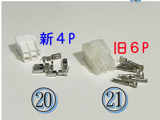
Yaesu ICOM 新旧電源コネクタ
